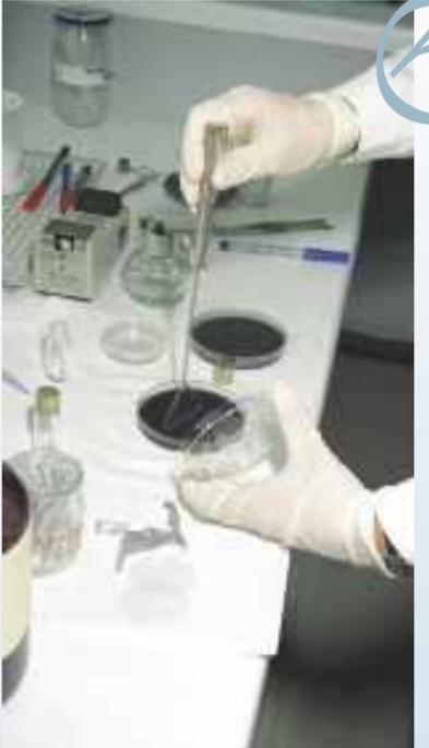
La potabilidad del agua se comprueba mediante **análisis**, tanto en la propia ETAP de La Perdiz como en la salida de los depósitos de almacenamiento, y en la red de distribución. Desde el laboratorio de análisis de la EMA, situado en la misma ETAP, se hace un **constante seguimiento** de la calidad del agua en todo su recorrido, analizándose más de 60 parámetros distintos con el fin principal de mantener las **máximas garantías de seguridad** para el consumidor.
