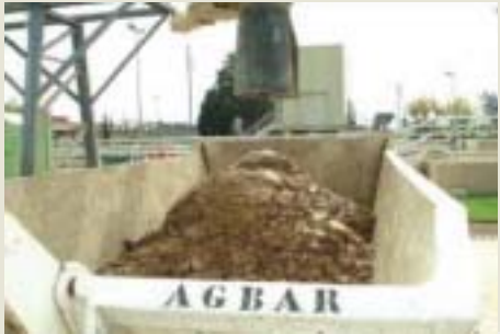
Figura 5. Descarga de lodos deshidratados en contenedor abierto.
