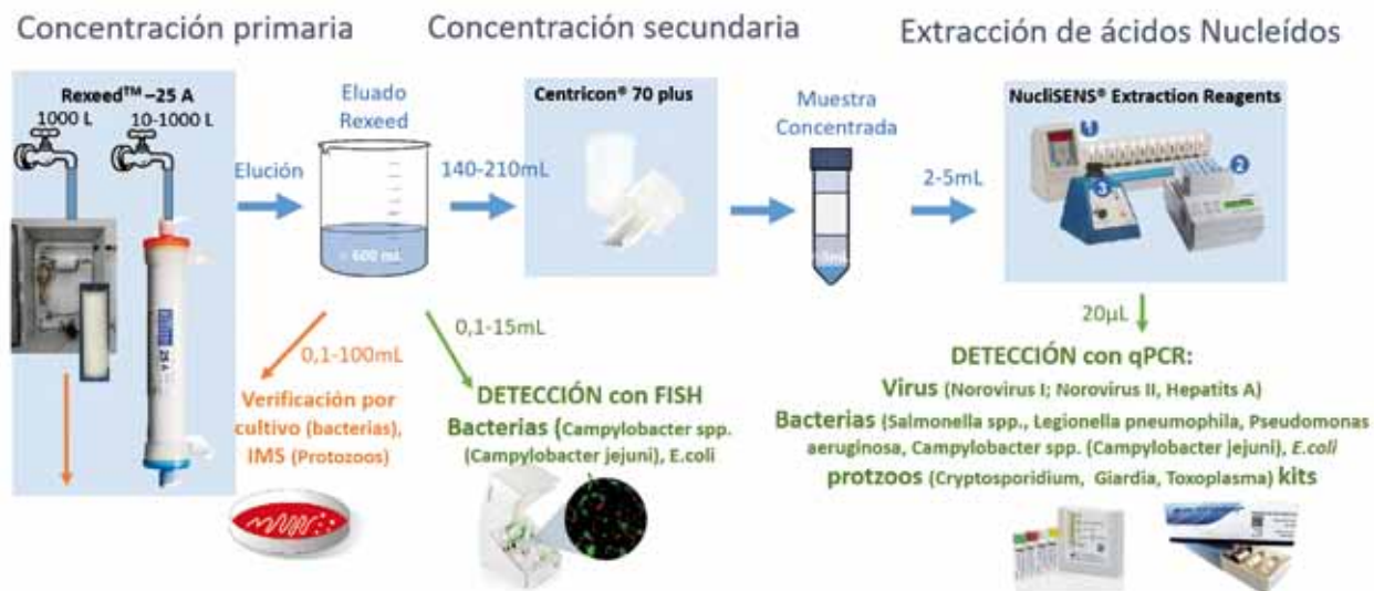
FIGURA 3. Esquema del protocolo a realizar y patógenos a analizar en una muestra. Fuente: Cetaqua y Aigües de Barcelona. En naranja, métodos de verificación. En verde, métodos desarrollados en el proyecto Aquavalens.
