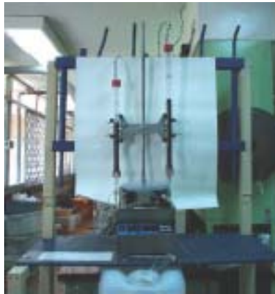
Figura 1. Sistema experimental empleado en las pruebas de adsorción del MIB, a régimen continuo.
